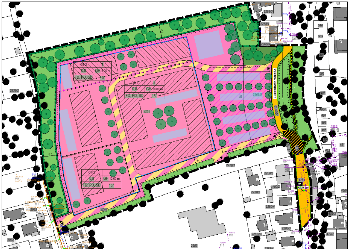
Darstellung der Versickerungsflächen (hellblau) für die Dachentwässerung
