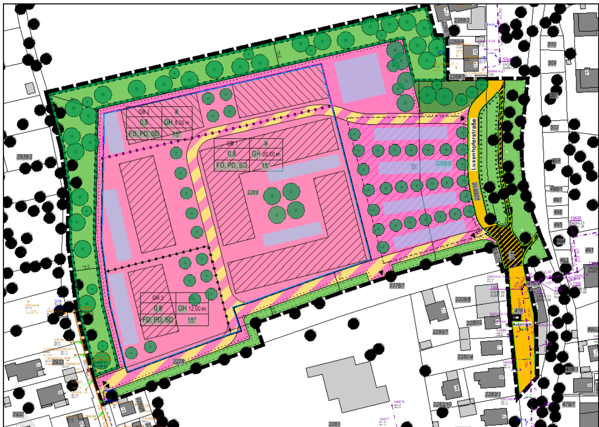
Darstellung der Versickerungsflächen (hellblau) für die Dachentwässerung
